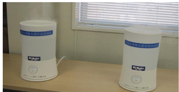
⑥ 次亜塩素酸水による超音波式噴射器
